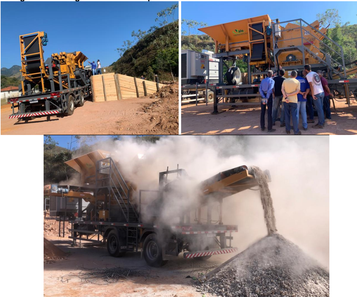
Figura 55: Entrega e treinamento operacional da Usina Móvel de Processamento de RCC.
